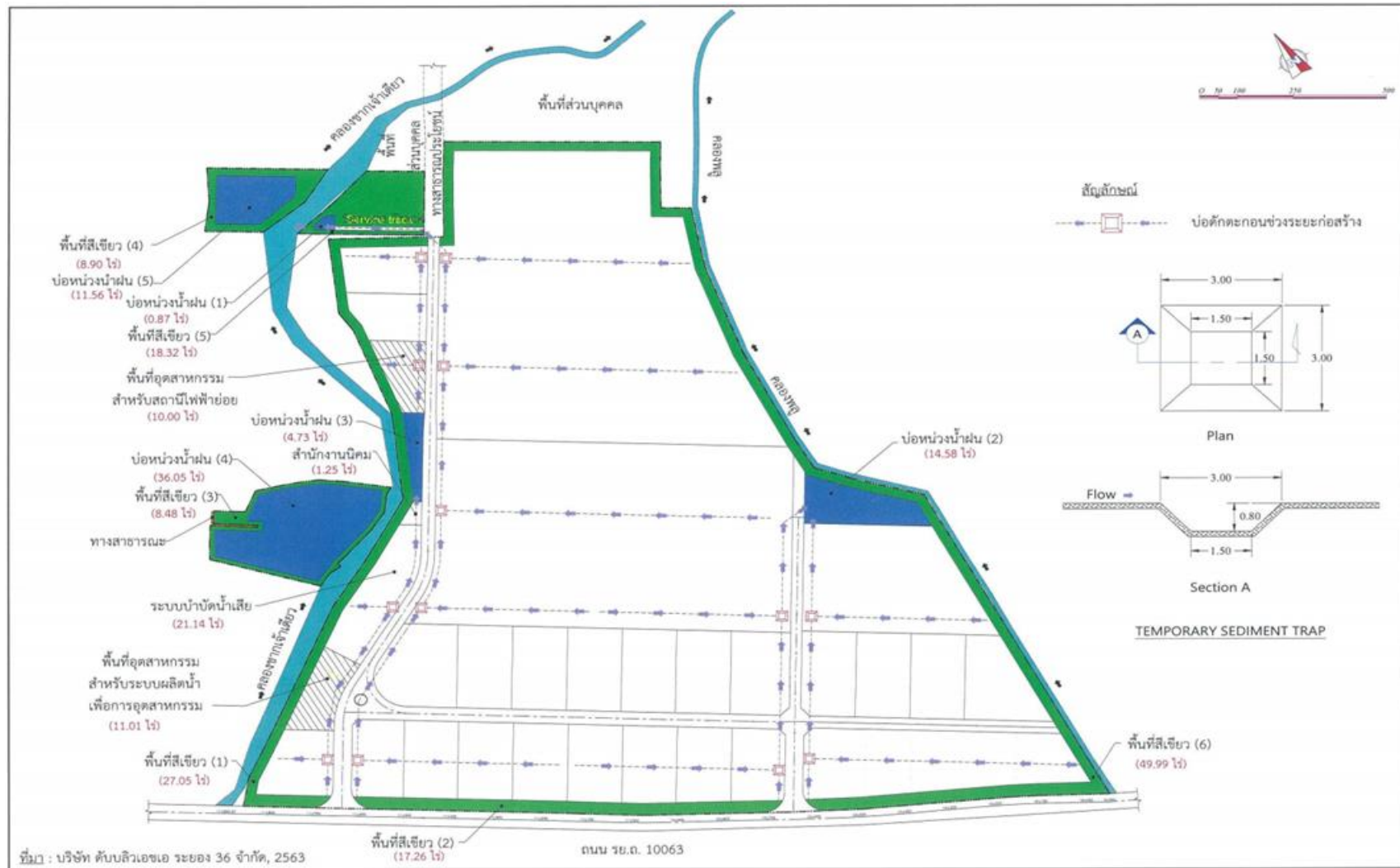
รูปที่ 1-4 ตำแหน่งและภาพตัดขวางบ่อตกตะกอนช่วงก่อสร้าง
